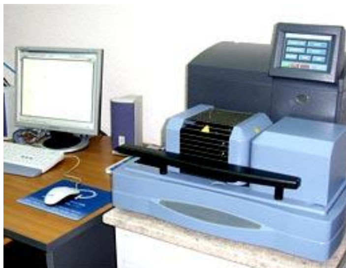
Рисунок – 6 ТГА/ДСК/ДТА анализатор SDT Q600
