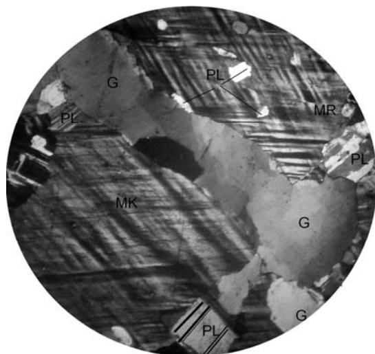
Рис. 7. Графическая структура леопардового пегматита Е-11: МК-микроклин, G - ихтиоглипты кварца разных систем (разновременное угасание), PL – плагиоклаз. Увеличение 45 x . Николи+
