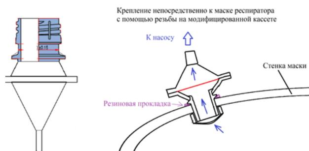
Рисунок 3. Схема пробоотборника
