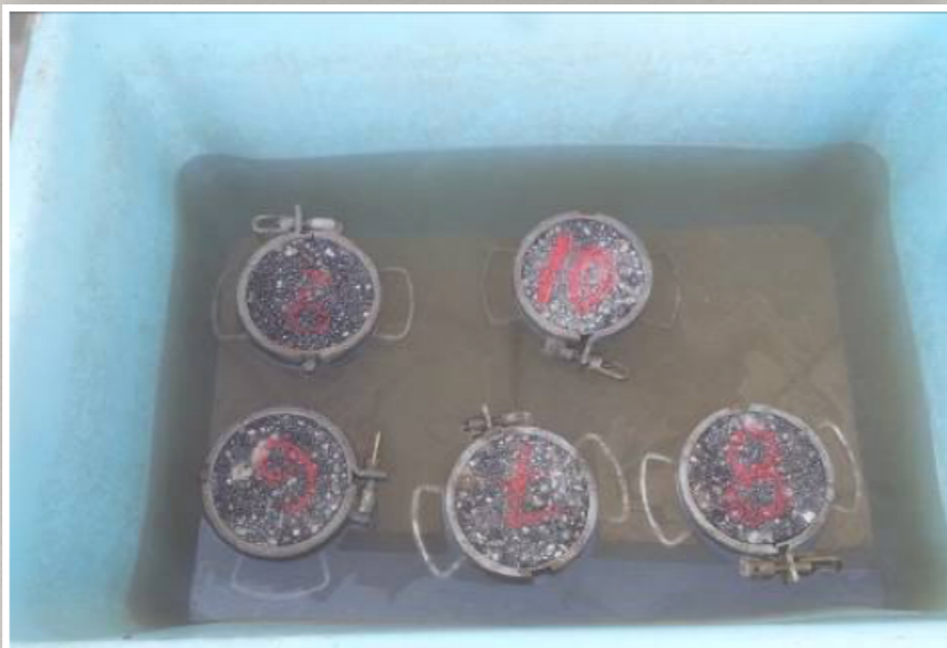
Figura 52. Las 5 probetas mixtas que se han conservado en el exterior del laboratorio y sumergidas en agua.
