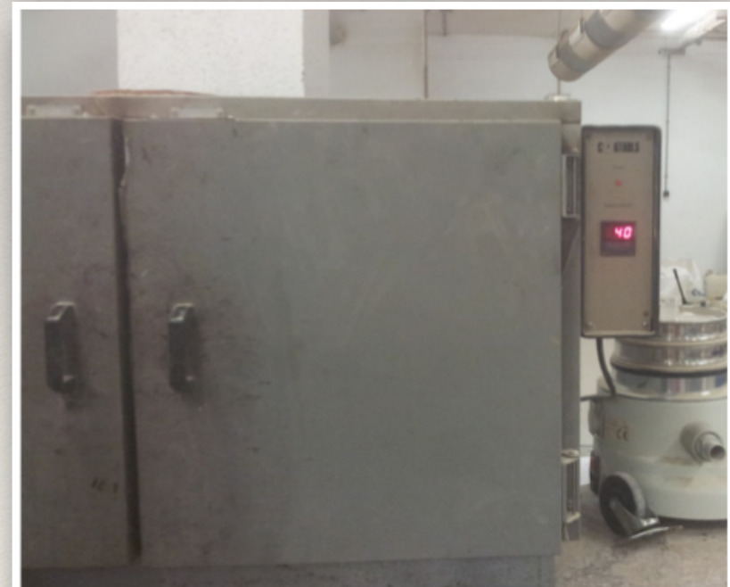
Figura 54. Fotografía de la estufa donde se han conservado las 5 probetas mixtas secas a 40°C
