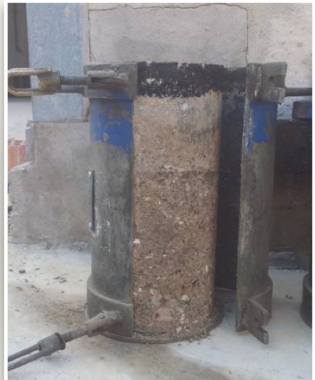
Figura 50. Probeta número 1. Se ha abierto el molde para visualizar la composición de la probeta. Se pueden observar las tres capas, el suelo, la zahorra (más clara) y la rodadura bituminosa.
