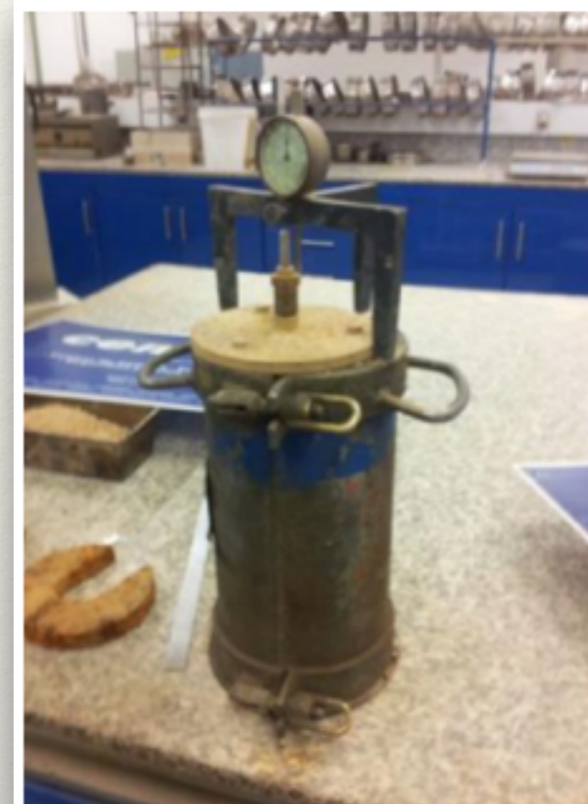
Figura 56. Sistema de medida de variación de volumen de las probetas mixtas.
