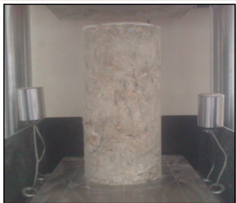
Figura 105. Ensayo de resistencia a compresión del HCR
