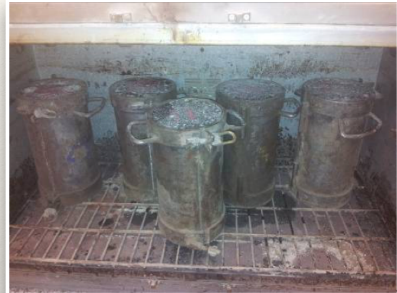
Figura 53. Las 5 probetas mixtas que se han conservado secas en estufa de laboratorio a 40°C.
