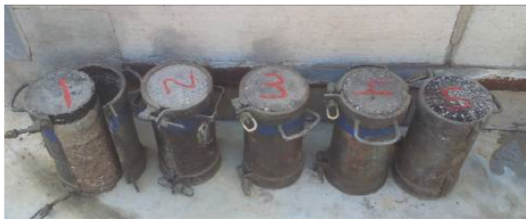
Figura 48. Las 5 probetas mixtas que se han conservado al aire, secas.
