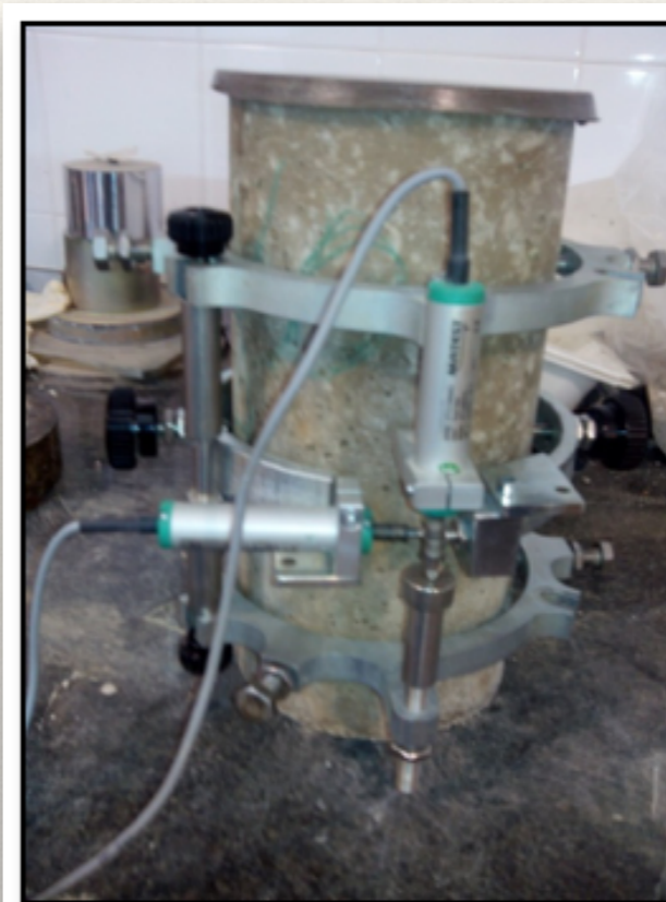
Figura 106. Probeta preparada para el ensayo de cálculo del módulo de elasticidad
