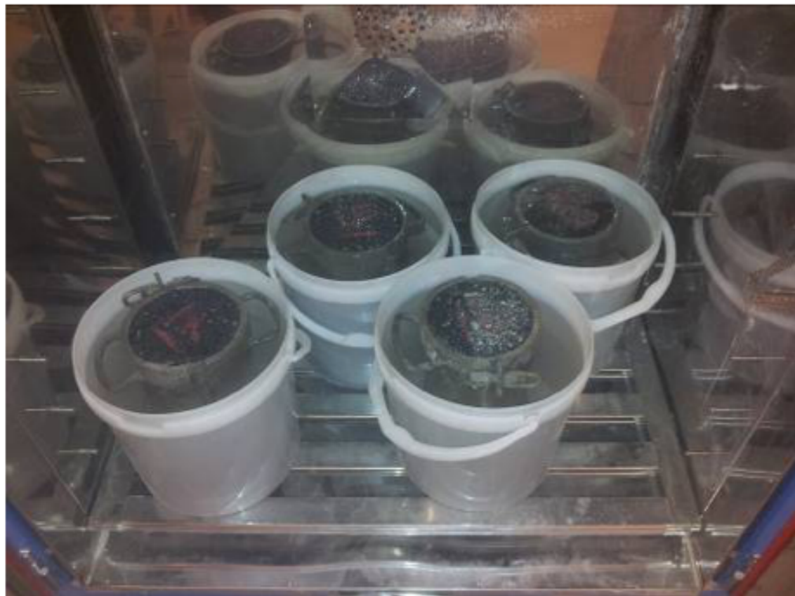
Figura 55. Fotografía de cuatro de las cinco probetas mixtas que se han conservado en húmedo en estufa de laboratorio a 40°C.
