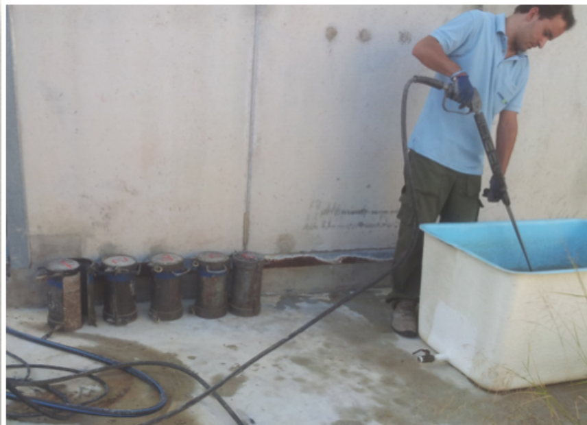
Figura 51. Llenado de agua la piscina donde fueron conservadas las probetas mixtas a temperatura ambiente (en el exterior del laboratorio) y sumergidas en agua.
