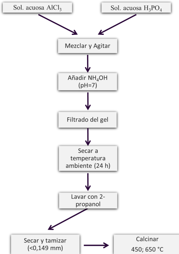
Figura A.1. Esquema de los pasos seguidos para la síntesis del fosfato de aluminio.
