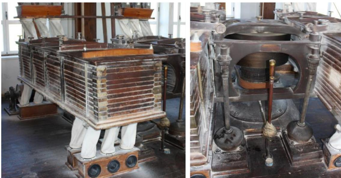
Figura 44: Planchister en funcionamiento, fábrica de harinas Santa Marta.
