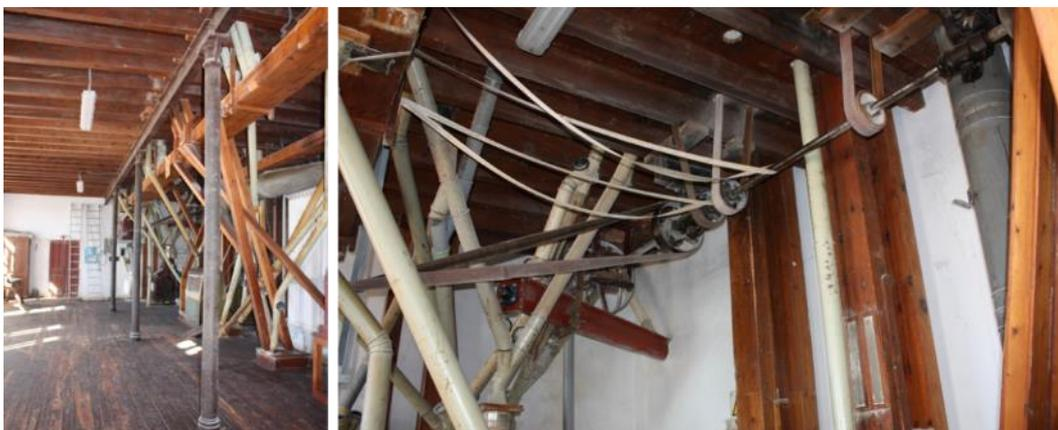
Figura 4: Planta primera, también llamada de caídas. Se ve en el techo el eje que mueve las máquinas de planta segunda.
