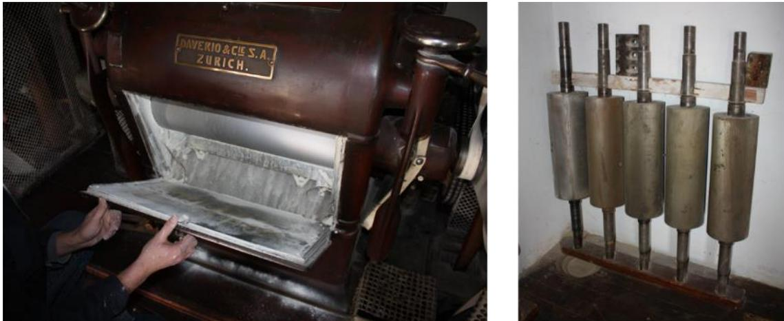
Figura 42: Molino de la casa “Daverio” en funcionamiento y rodillos en la fábrica de harinas Santa Marta
