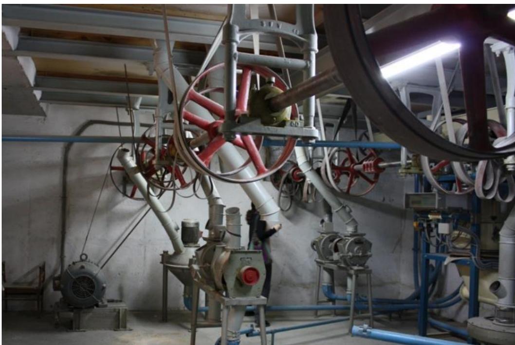
Figura 6: Transmisión de la fábrica antigua con motor al fondo.
