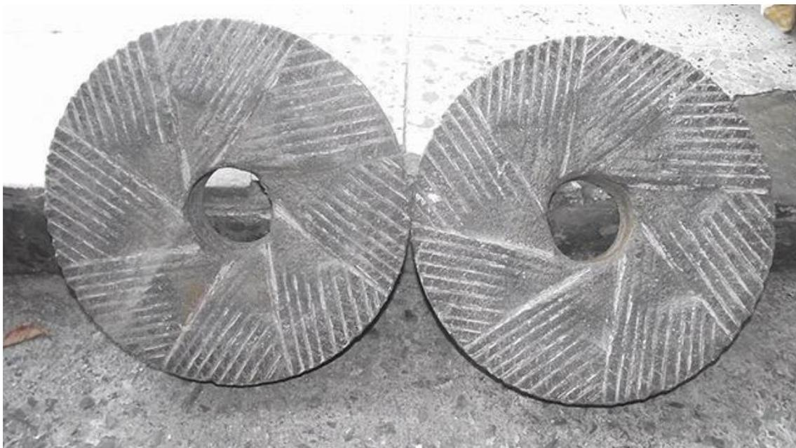
Figura 38: Piedras de molino con estriado.
