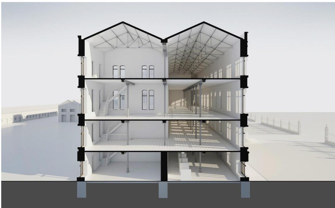
Figura 90: Sección y recreación virtual del interior de la fábrica Fontecha y Cano SA. Ubicación de pórticos, forjados y cerchas de cubierta.
