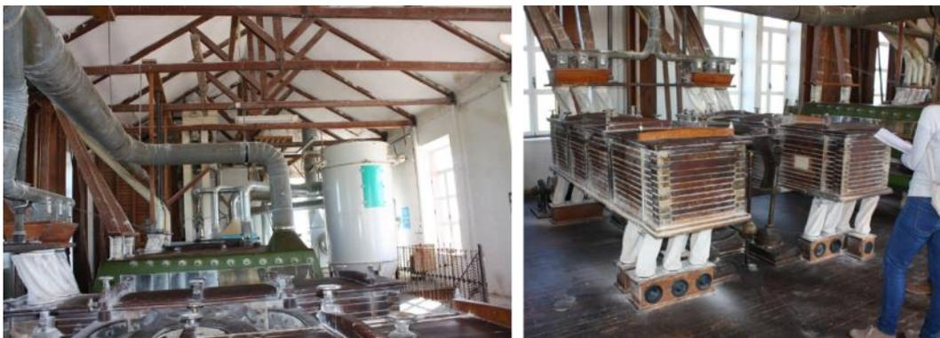
Figura 5: Planta segunda donde se sitúan los planchisters, que realizan el cernido y clasificación de las harinas.
