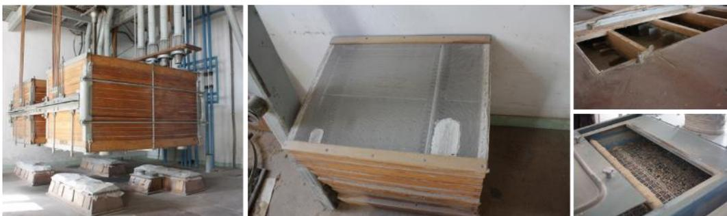
Figura 9: Planchister y cedazos para la clasificación de harinas. Las dos últimas imágenes son los procesos de clasificación de harinas y deschinado del trigo.
