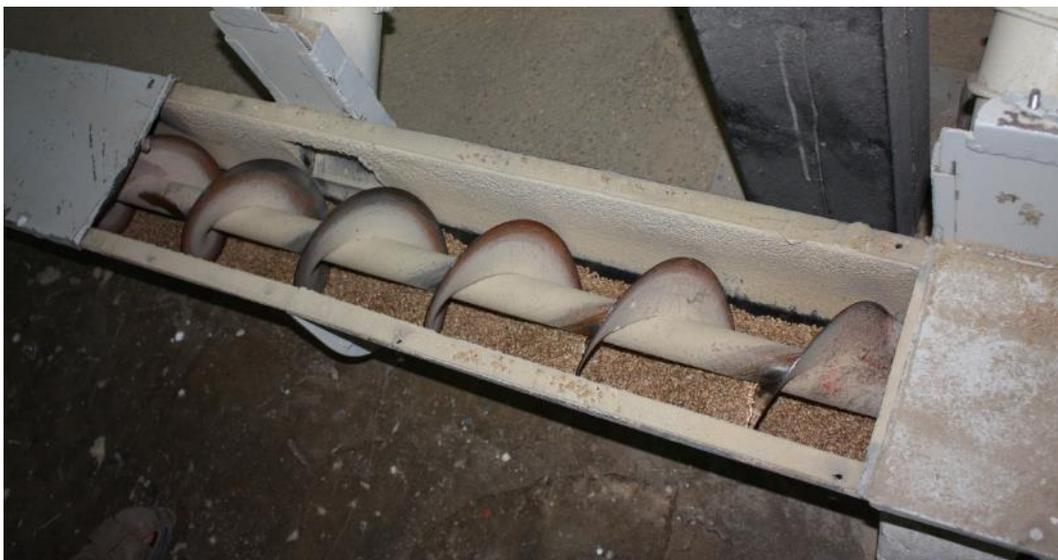
Figura 10: Tornillo sin fin que sirve para transportar el trigo a los diferentes procesos de acondicionado.
