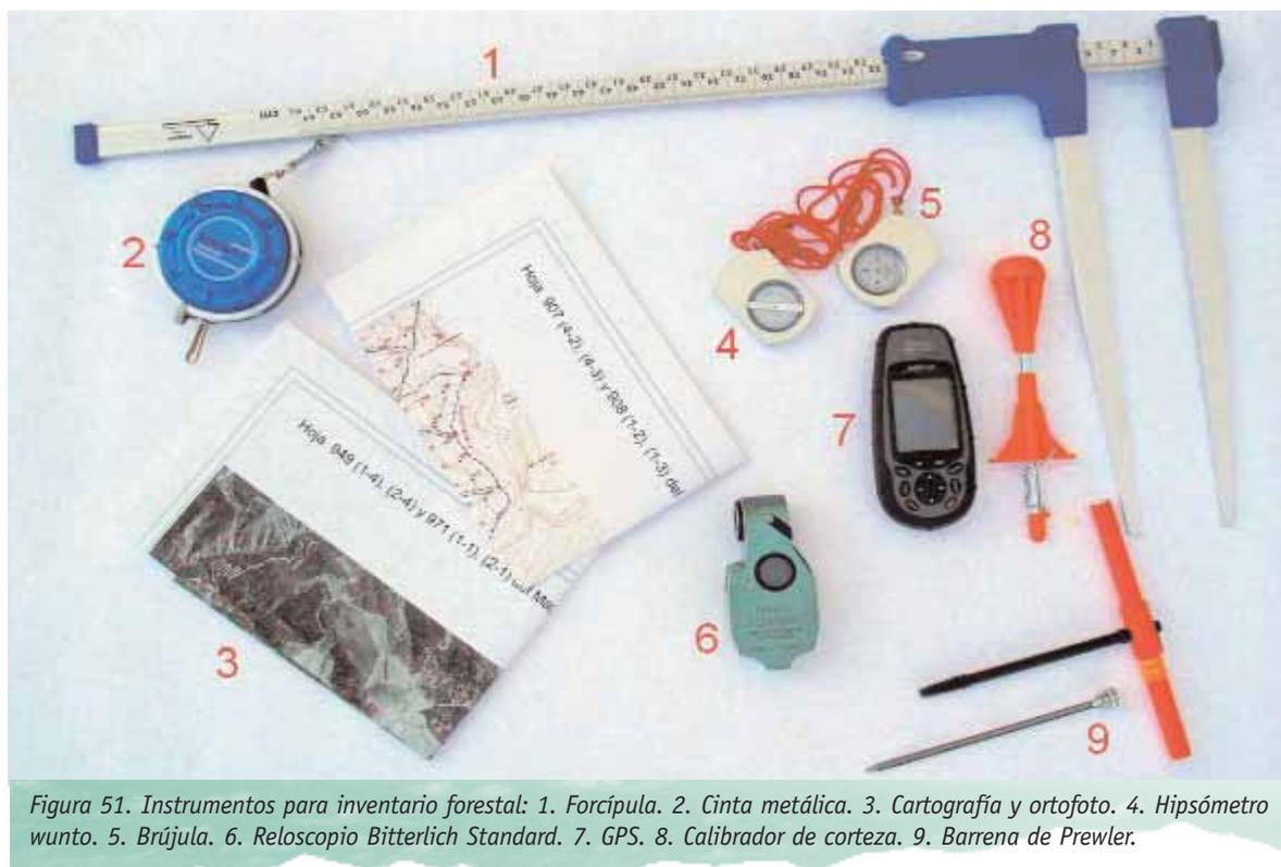
Figura 51. Instrumentos para inventario forestal: 1. Forcípula. 2. Cinta metálica. 3. Cartografía y ortofoto. 4. Hipsómetro wunto. 5. Brújula. 6. Reloscopio Bitterlich Standard. 7. GPS. 8. Calibrador de corteza. 9. Barrena de Prewler.
