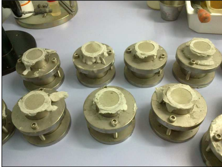
Figura 25. Moldes con mortero de referencia
