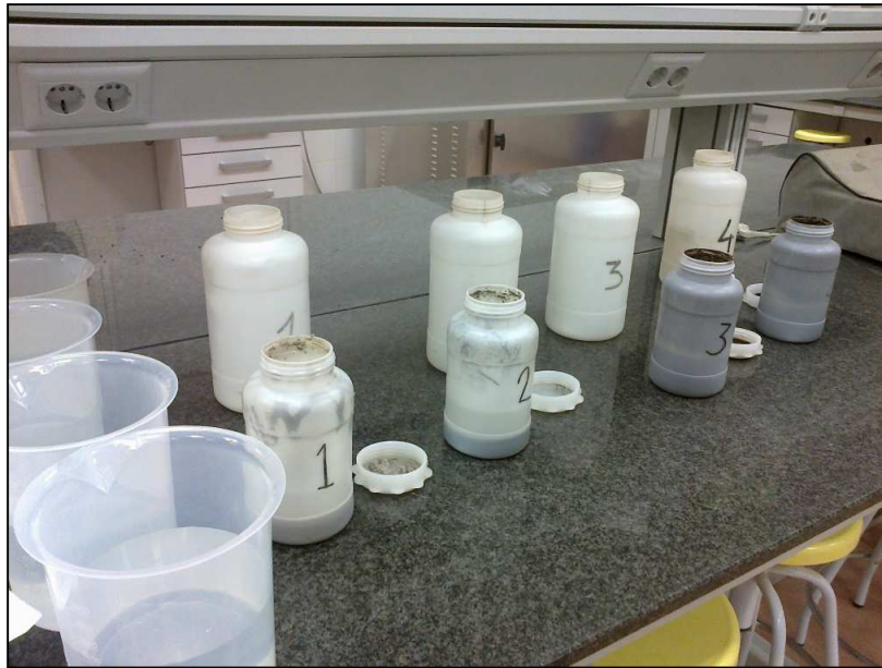
Figura 31. Lixiviación según norma UNE EN 12457-3
