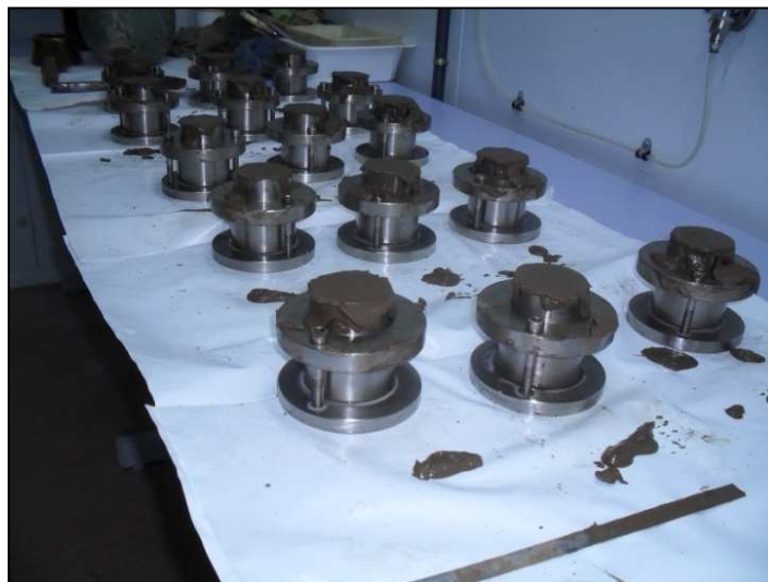
Figura 24. Moldes cilíndricos rellenos de mortero y enrasados
