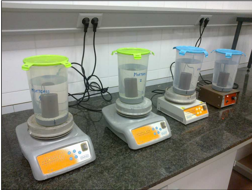
Figura 29. Lixiviación según norma XP X31-212
