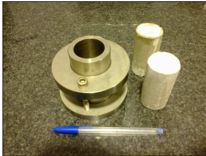
Figura 8. Molde cilíndrico y probetas
