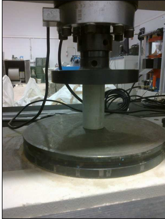
Figura 27. Resistencia a compresión de probeta cilíndrica
