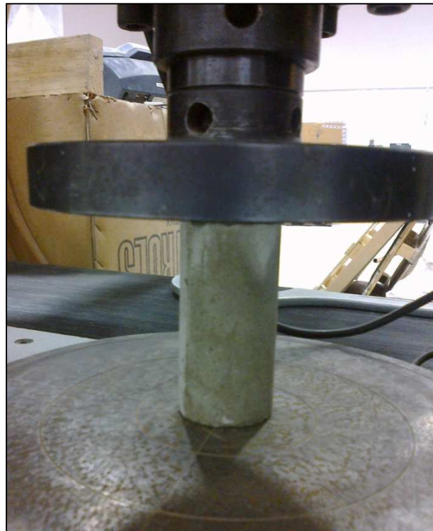
Figura 10. Rotura de probeta a resistencia a compresión
