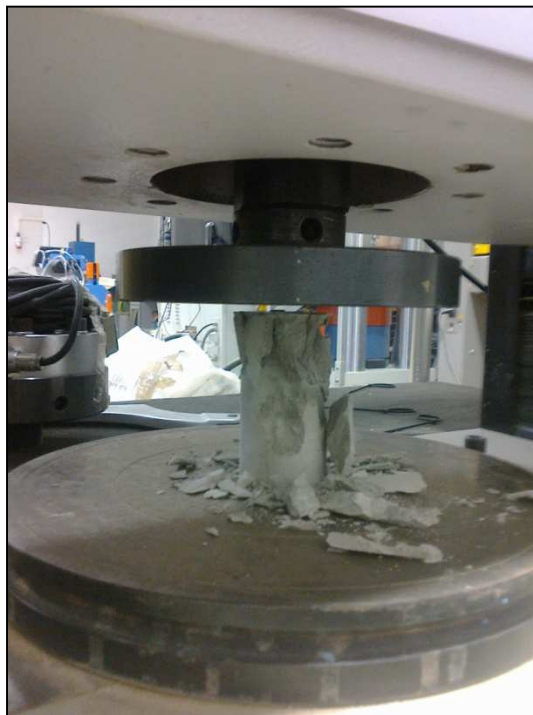
Figura 28. Rotura de probeta a resistencia a compresión
