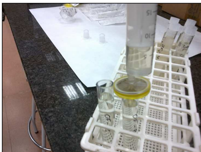
Figura 4. Filtrado mediante membrana de 0,45 \mu\text{m}
