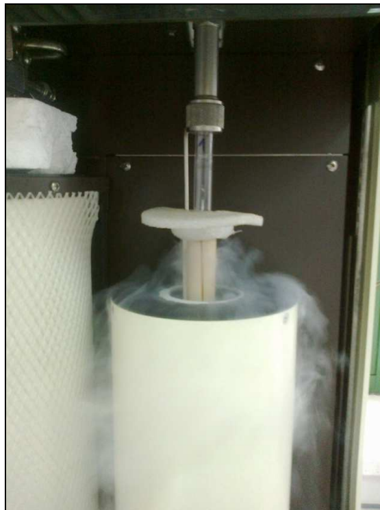
Figura 7. Muestra en ensayo de superficie específica
