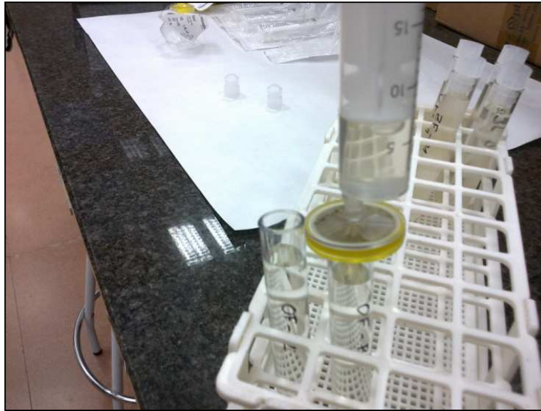
Figura 33. Filtrado mediante membrana de 0,45 \mu\text{m}
