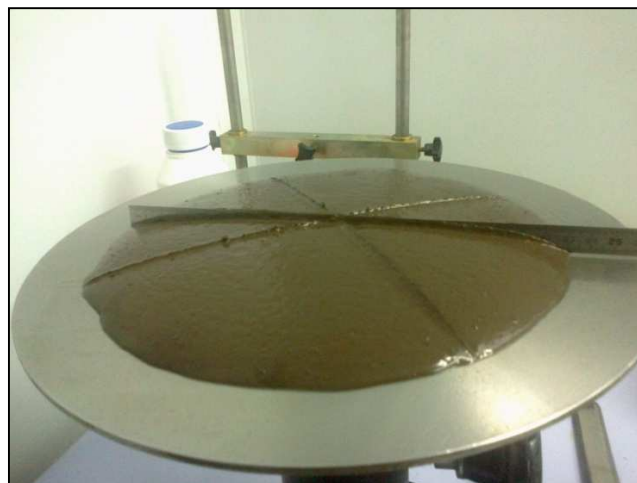
Figura 22. Ensayo de consistencia
