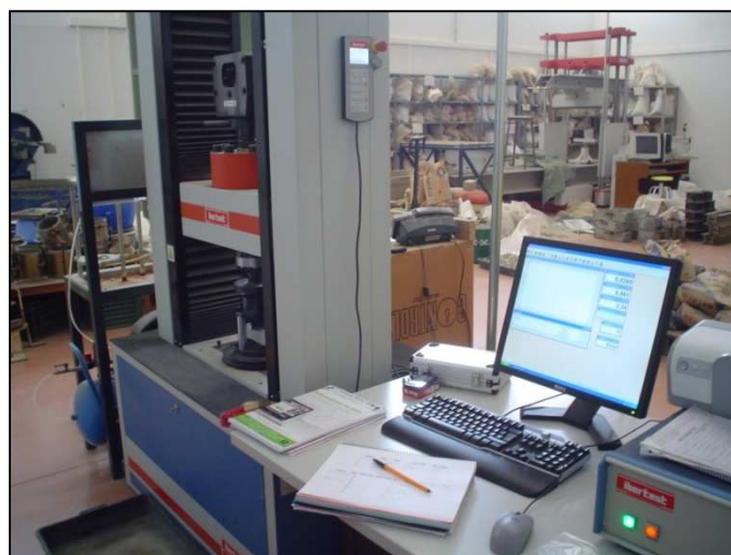
Figura 9. Máquina electromecánica. Modelo ELECTROTEST-300-MD2
