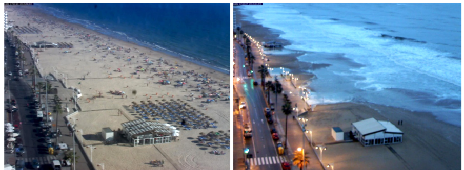
Fig. 3. Estado de la playa de la Victoria (Cádiz) en condiciones de buen tiempo (izquierda) y durante una marea meteorológica (derecha). Las mareas meteorológicas favorecen la llegada del agua a los chiringuitos de la playa.
