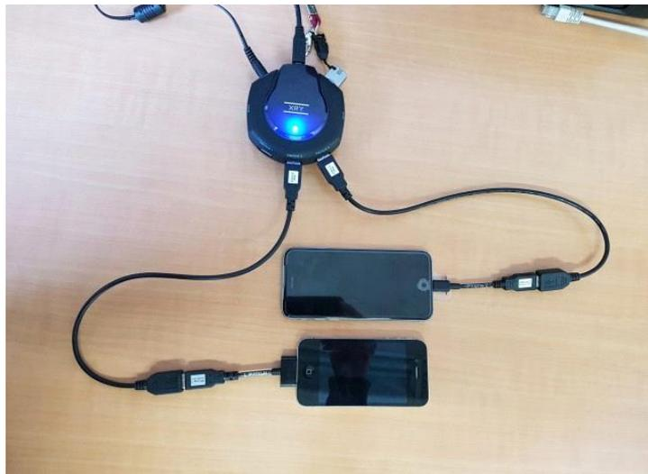
Figura 4 – Hub XRY com os dispositivos móveis ligados.
