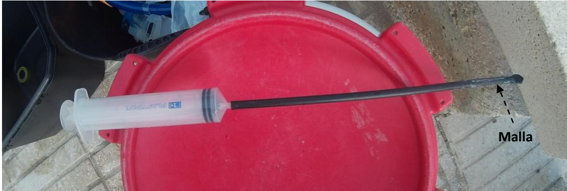
Figura 4. Imagen de la bomba manual con lanceta y malla de 200 \mu m de luz.
