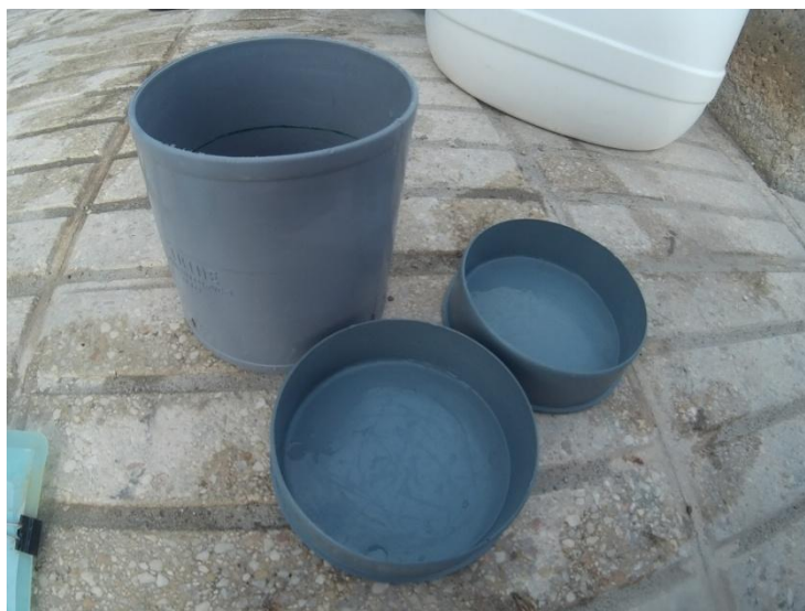
Figura 3. Imagen del core de 8,2cm de profundidad y 122cm 2 de área.
