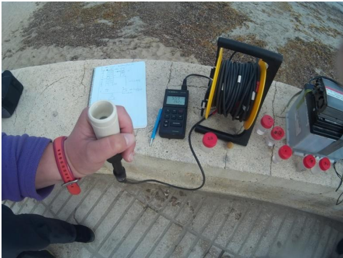
Figura 1. Imágenes de la medición del oxígeno disuelto y del potencial redox del agua intersticial del sedimento, respectivamente.
