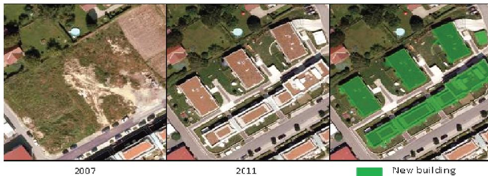
Fig. 6: Richtig detektierte neue Gebäude.
