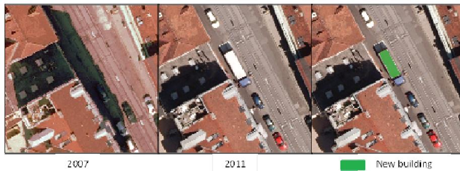
Fig. 19: Ein Lastwagen, fälschlicherweise als neues Gebäude klassifiziert.
