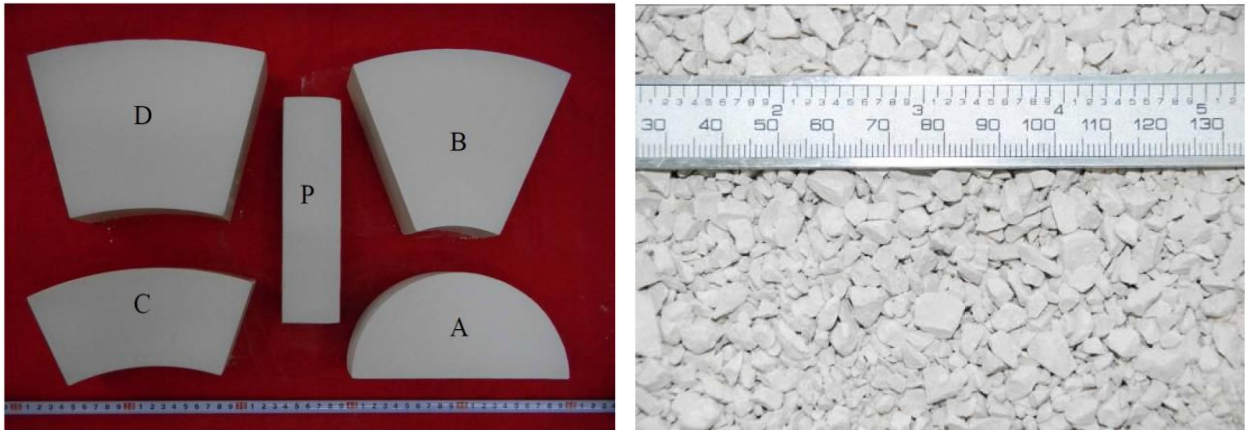
Bild 5.28 Kompaktierte Bentonitblöcke (links) und Bentonitbruchstücke aus dem kompaktierten Bentonitblock P (rechts), Liu et al. (2013)
