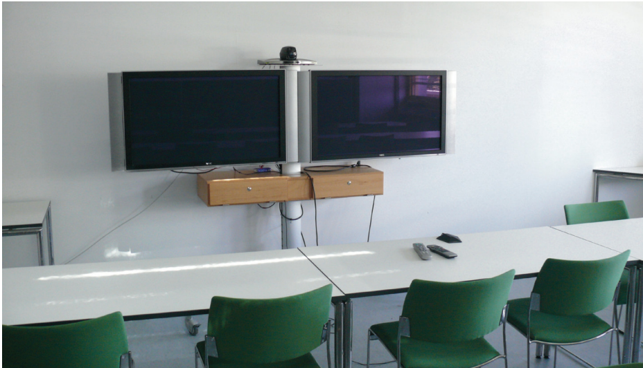
Abbildung IV.3: Videokonferenzsystem Tandberg 990 MPX im „MuVi-Raum“ des IT-Servicezentrums (NW II, 3.2.00.336)
