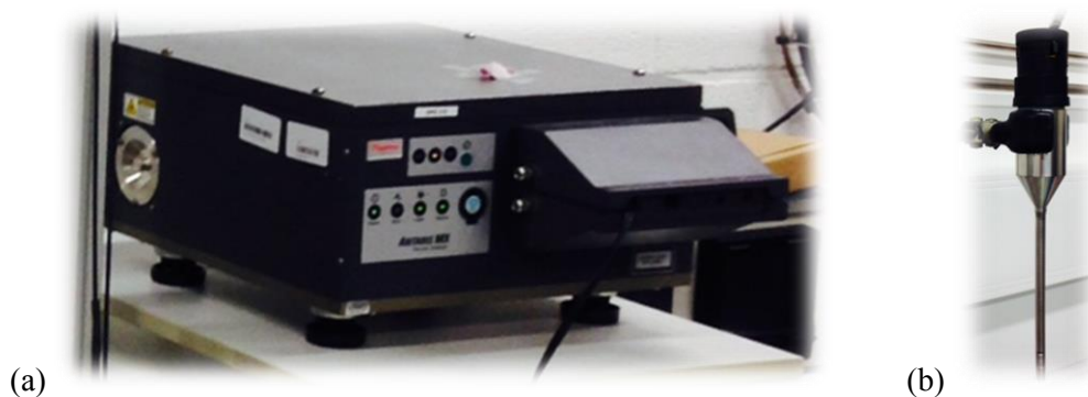
Figure IV.9 – Dispositif pour la mesure en ligne de la conversion d'alpha-pinène : (a) spectromètre proche infrarouge, (b) sonde à transflection.
