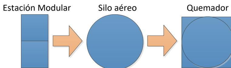
Esta alternativa consta de un silo aéreo en el que se almacena el stock de pellet necesario. A medida que un camión llega a la planta, los Big Bag se descargan dentro del silo, alimentados por el mismo sistema modular mencionado en la alternativa 1. De esta manera, el pellet queda seguro y no se debe disponer de un gran espacio para almacenaje de Big Bag.
