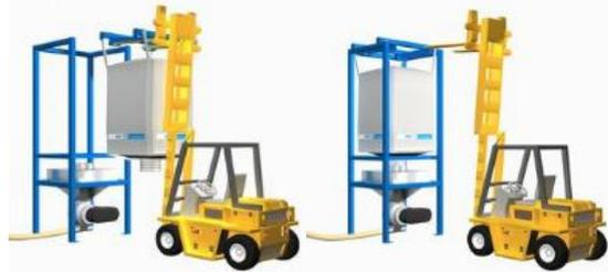
e. Manipulación de Big Bag para descarga del camión y carga de sistema modular
