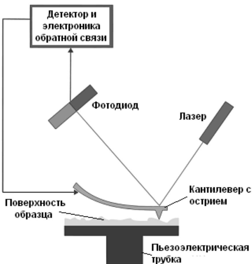
Рис. 3.32. Принципиальная схема атомно-силового микроскопа
