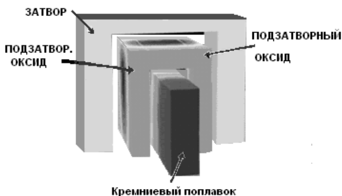
Рис. 1.11. Структура активной зоны поплавкового транзистора с двойным затвором
