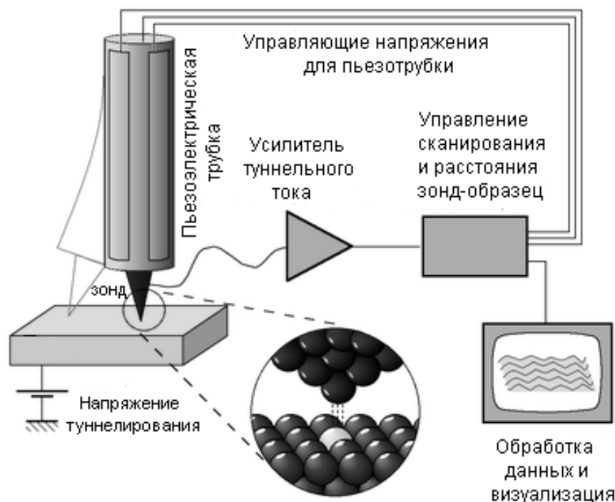
Рис. 3.31. Принципиальная схема сканирующего туннельного микроскопа
