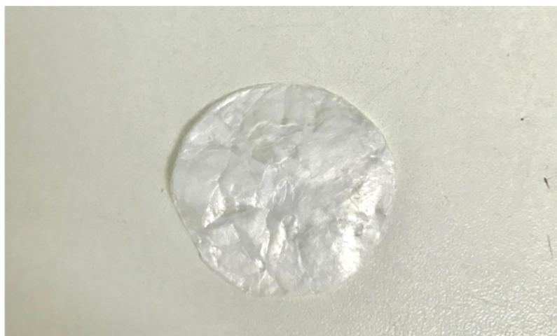
Figura 5 - Membrana de nanocelulose Bacteriana (IntelLAB - UFSC)
