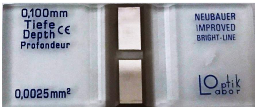
Figura 10 - Câmara de Neubauer para avaliação da viabilidade celular em microscopia
