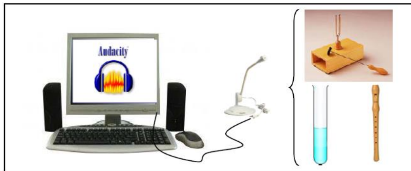
Fig.1. Esquema del sistema i el material utilitzat per la realització de l'experiència.
