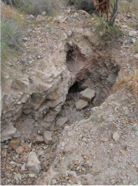
Figura 3.72. Interior de la Calicata Dolores. Se observan varios agujeros y bloques de gran tamaño arrancados por los coleccionistas de minerales. Los bloques del fondo marcan el inicio de la galería colapsada.
