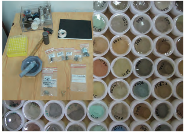
Figura 2.5. Materiales empleados en la preparación de las muestras (izquierda) y resultado final (derecha), con las muestras preparadas para el análisis
