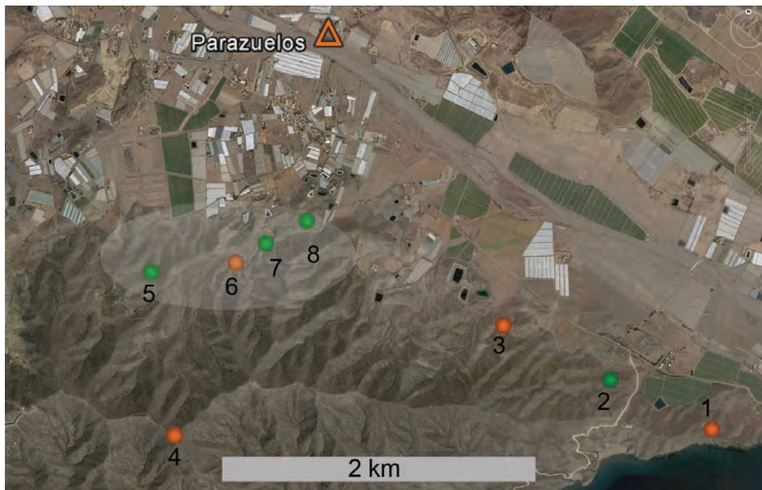
Figura 3.66. Indicios de hierro (naranja) y hierro-cobre (verde) entre 1 y 3 km al "sur" de Parazuelos. 1: Cerro de la Panadera; 2: Las Planas 1; 3: Las Planas 2; 4: Este de Lomo de Bas; 5: SW de la Casa del Moro; 6 a 8: S de la Casa del Moro.
