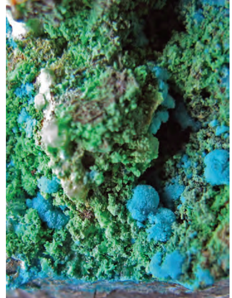
Figura 3.71. Cristalización de conicalcita y crisocola en una de las muestras. Ancho de la imagen 1 cm.
