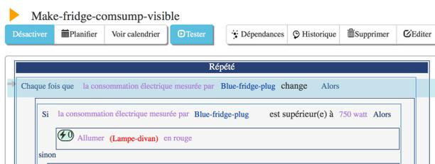
Figure 3: *Lampe-divan*, affichée en rouge, a disparu. L'indicateur d'exécution du programme *Make-fridge-consump-visible* (triangle en haut à gauche) est orange. Il repassera au vert dès la réapparition de *Lampe-divan*.
