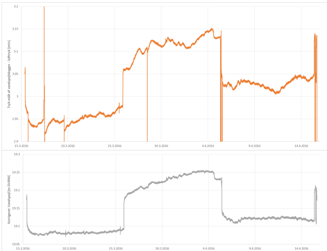
Figure 3.2: Korrektion af data fra pumpeforsøget. Den øverste, orange graf viser data, der ikke er korrigeret, mens den nederste grå graf viser de korrigerede data. De viste data er korrigeret for barometereffekt (korte udsving, ca. 1-2 cm i amplitude) og lineær trend (generel stigende tendens, ca. 5 cm over den viste tidsperiode).
