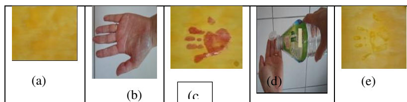
Figura 3 – Problematização do experimento com indicadores ácidos-bases, sendo: (a) folha de papel pintada com solução de açafrão em álcool etílico; (b) presença de sabão (íons hidróxido) em pedra sobre uma das mãos; (c) resultado da sobreposição da mão, contendo sabão, sobre o papel com o indicador de açafrão; (d) presença de
