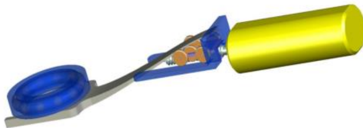
Figure 2.13: Dispositif d'actionnement électromécanique d'embrayage conçu par Ricardo (Wheals et al. 2009)
