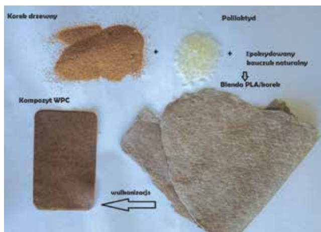
Fot. 3. Napełniacz z korka, kompozyty PLA z korkiem (fot. A. Wieczorek)
