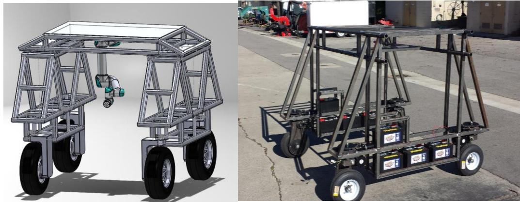
a) b) Figure 1. a) SolidWorks design b) actual robot
