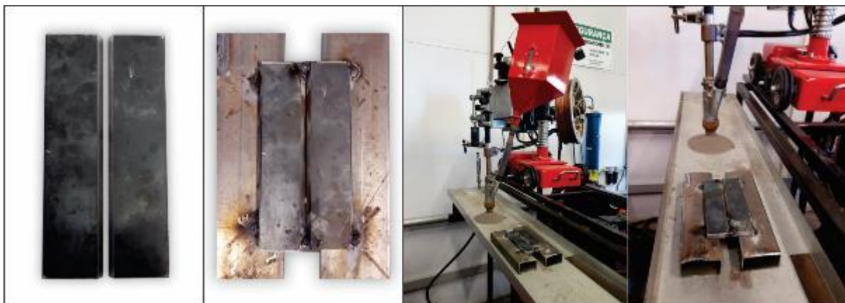
Figura 23 – Chapas de aço soldadas para definição dos parâmetros
