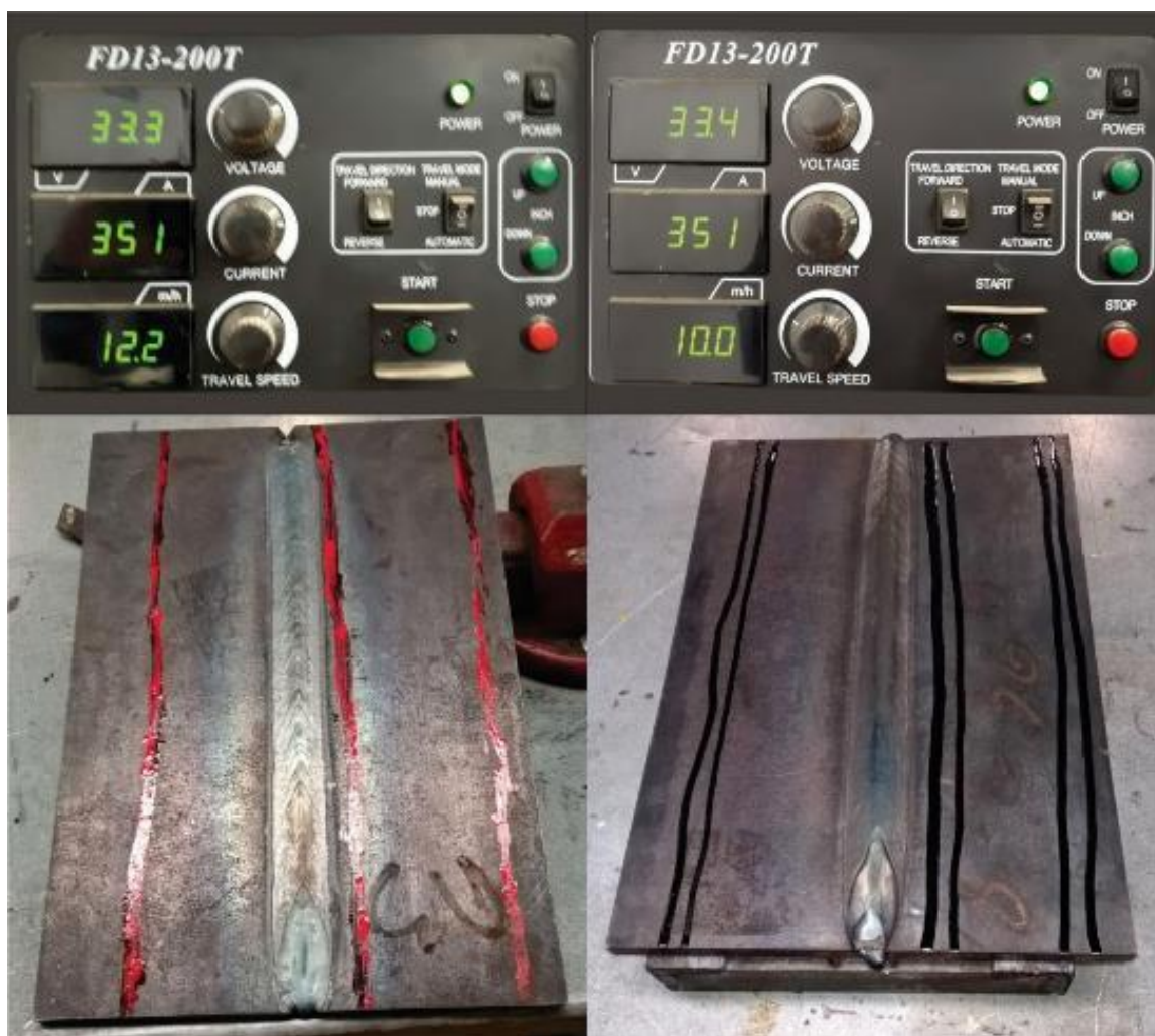
Figura 26 – Parâmetros com chapas soldadas
