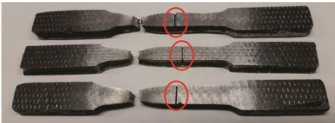
Figura 41 – Agravamento de defeito do cordão de solda
