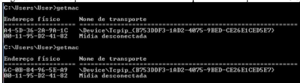
Figura 27- Endereço MAC do PC “A” antes e depois da execução do MAC spoofing
