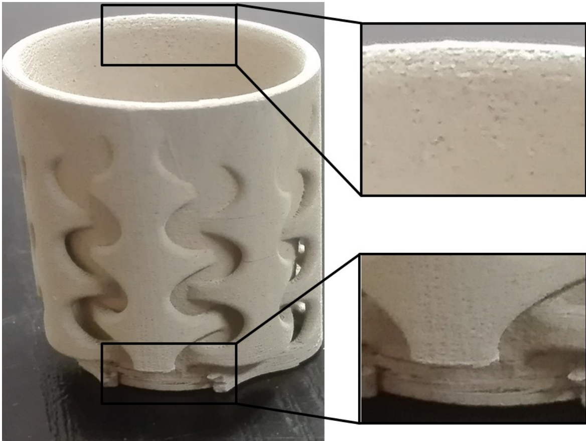
Abb. 4.49: Lasergesinterter Becher komplexer Geometrie aus Porz01 mit konstanter Laserleistung. Bodenbereich weist Delamination auf; im oberen Bereich sind Überhitzungserscheinungen wie Poren zu erkennen
