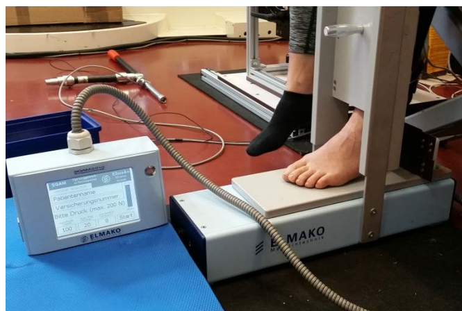
Abb. 6: Sprunggelenksarthrometer (SGAM 2013) zur Quantifizierung des anterioren Talusvorschubes
