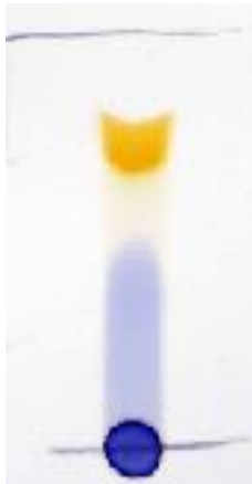
Abbildung 11: Aufnahme eines DC-Chromatogrammes mit Originalmaterial; Die deutlichste Trennung der blauen und gelben Farbstoffe konnte mit Ethanol als Fließmittel erreicht werden.
