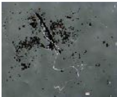
Abbildung 30: Mikroskopaufnahme des Konsolidierungsergebnisses mit LIV (ORMOCERE-G/Paraloid B72). Das Benetzungsvermögen ist adäquat und es haben sich kaum Lufteinschlüsse gebildet (Maßstab: 2mm).
