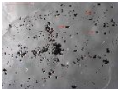
Abbildung 29: Mikroskopaufnahme des Konsolidierungsergebnisses mit LII (Paraloid B72); Die Pfeile zeigen auf Lufteinschlüsse, welche sich um die Farbstoffteilchen herum gebildet haben (Maßstab: 2 mm).
