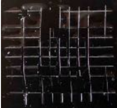
Abbildung 35: Aufnahme der Gitterschnittprüfung an LII (Paraloid B72); Exemplarisches Beispiel für die Bewertungskategorie 4.
