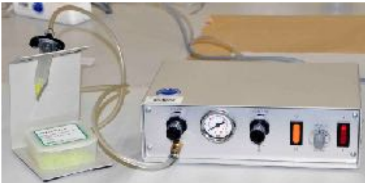
Abbildung 28: Aufnahme des BELO Dosiergerätes (rechts) mit einer VIEWEG Dosiernadel (links).
