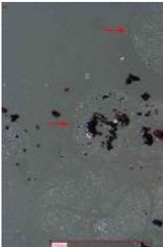
Abbildung 32: Mikroskopaufnahme des Konsolidierungsergebnisses mit LVII (Tecero-Wachs 30201/30410); Die Pfeile weisen auf den weißlichen Schleier hin (Maßstab: 2 mm).
