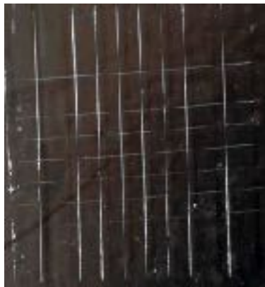
Abbildung 34: Aufnahme der Gitterschnittprüfung an LVI (ORMOCER_G/Paraloid B72); Exemplarisches Beispiel für die Bewertungskategorie 0.
