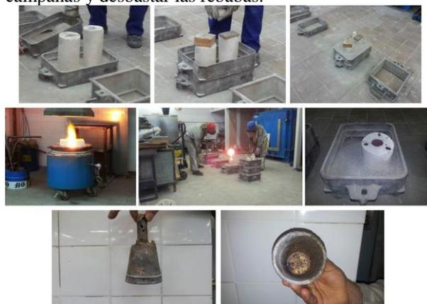
**Figura 3.** Proceso de obtención de una campana.
