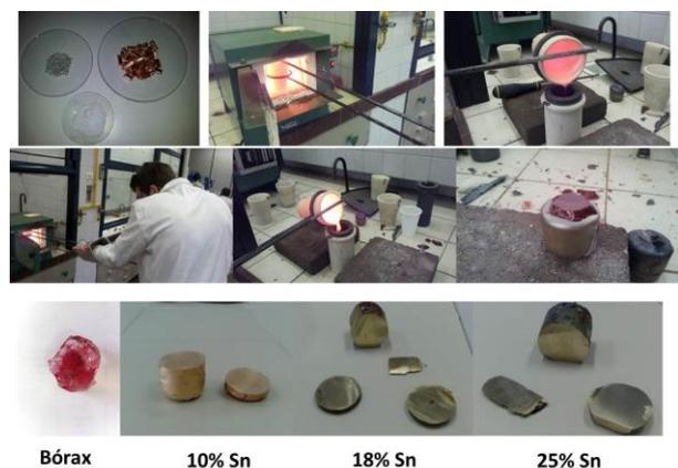
**Figura 1.** Proceso de obtención de las aleaciones.
