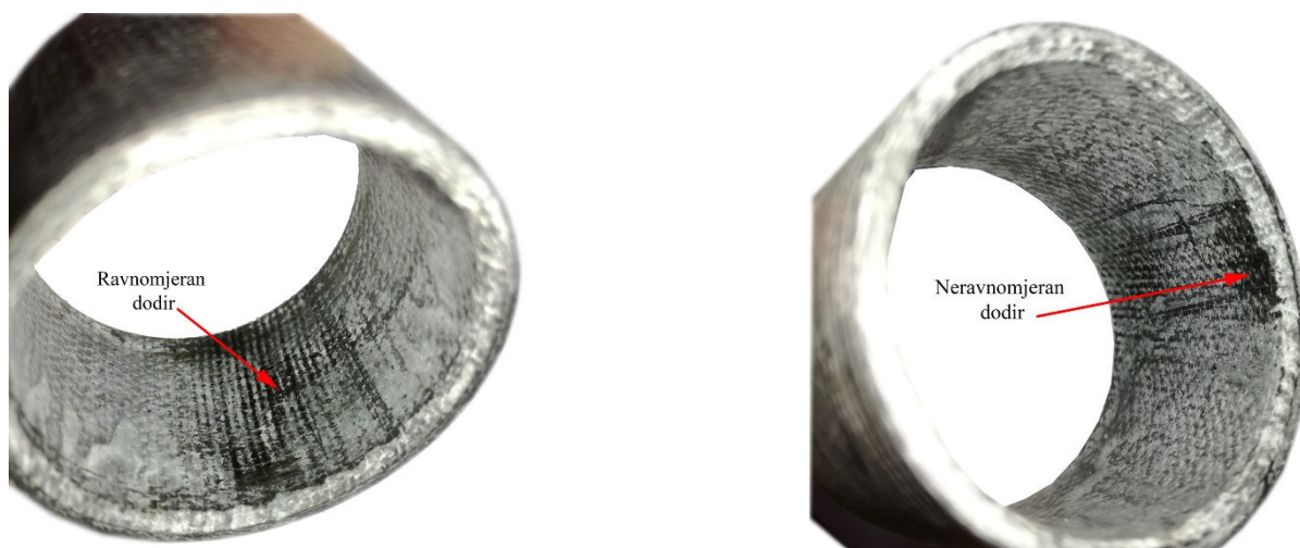
Slika 75. Ravnojeran i neravnomjieran dodir između kliznog ležaja s dodatkom maziva i rukavca
