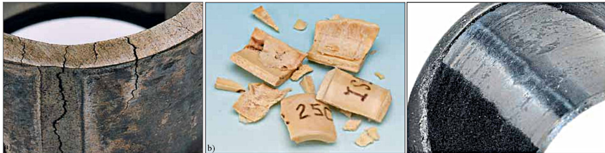
Slika 31. a) Oštećenje sinterirane bronce, b) oštećenje polimera sa staklenim vlaknima, c) oštećenje PA66 [61]
