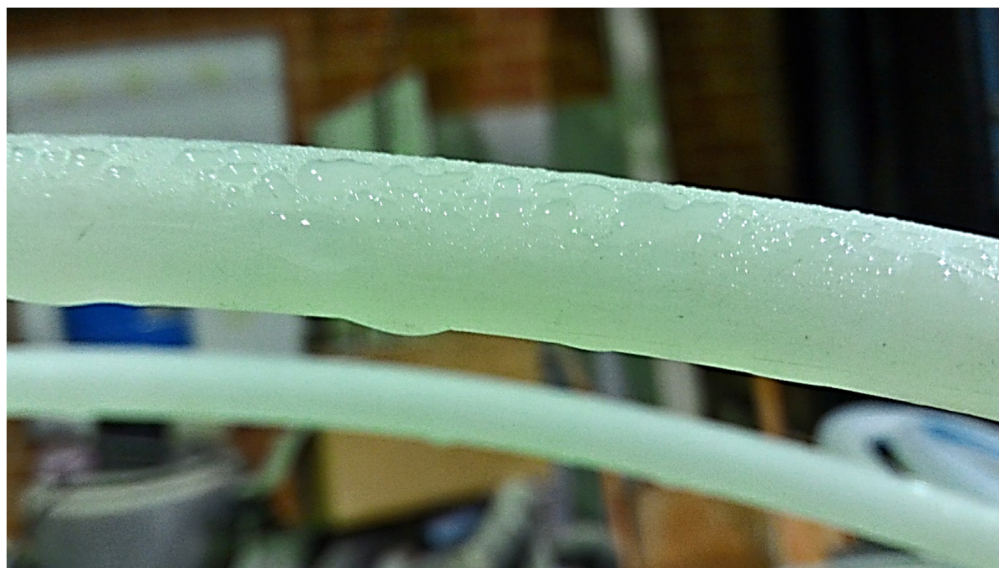
Figura 28. Formação de condensações durante o transporte da água
