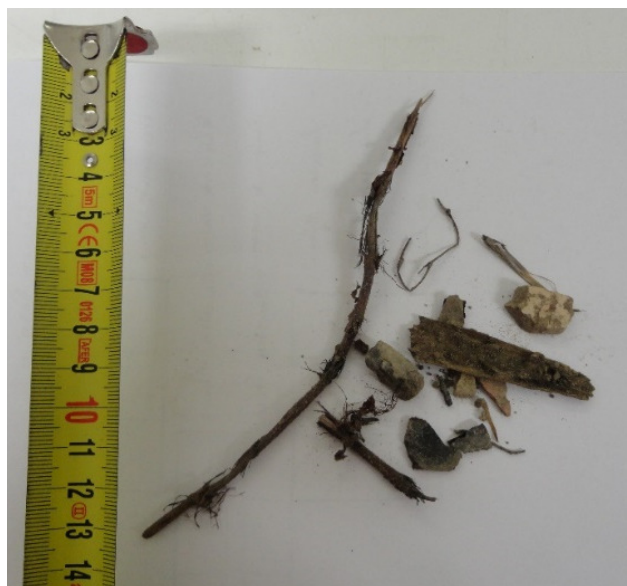
Figura 11. Matéria orgânica encontrada durante a desagregação
