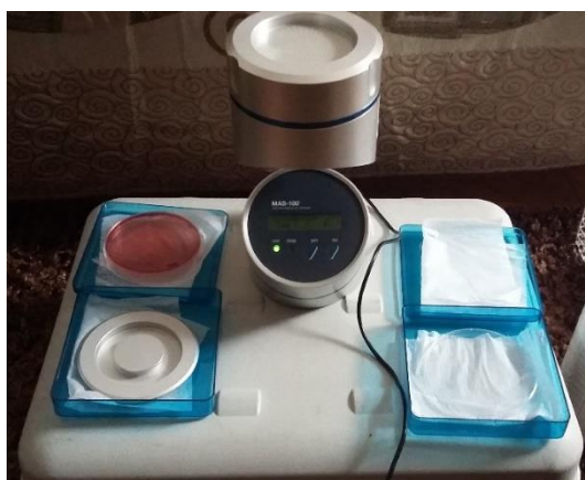
Figura 3. Amostrador de ar (Merck Air Sampler MAS-100) durante uma recolha de ar.
