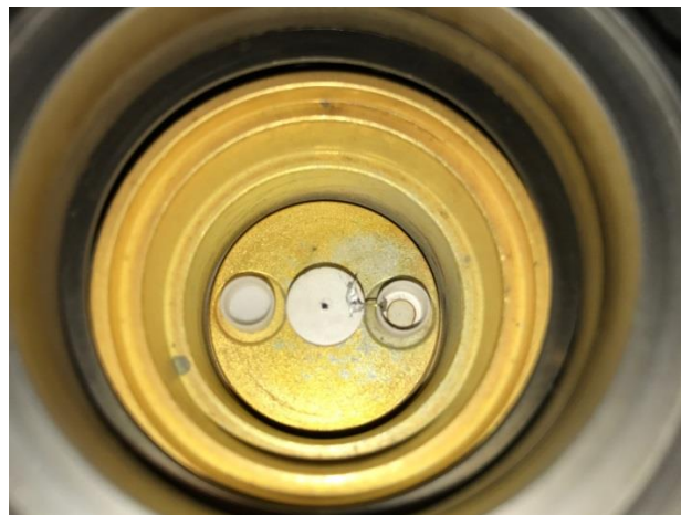
Abbildung 4.13 Bild von der inneren DSC-Messzelle mit Alumina-Tiegel für ECE-Messungen. Links: Referenz und Rechts: Probenseite mit einem kurzen Draht mit der Mitte der Zelle elektrisch kontaktiert
