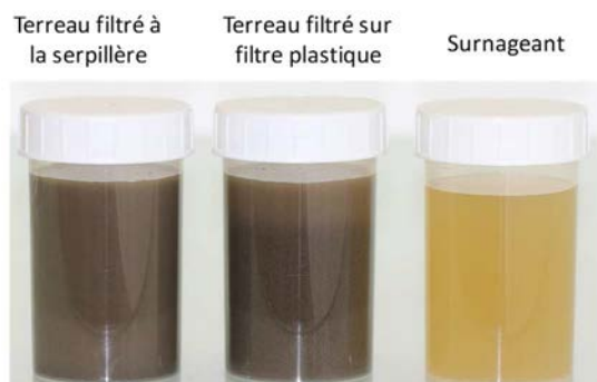
Figure 16. Inocula obtenus par diverses méthodes de filtration. De gauche à droite : terreau filtré à la serpillère, terreau filtré sur filtre plastique, surnageant.
