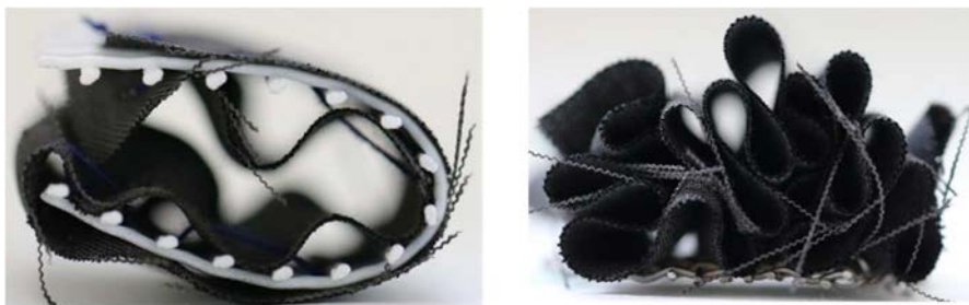
Figure 3. Exemples d'anodes tridimensionnelles utilisées dans les travaux de thèse.
