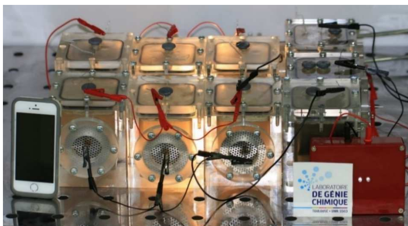
Figure 41. Photographie du prototype de démonstration « Bioelec » composé de neuf PCMs indépendantes connectées électriquement en combinant branchements en série et en parallèle.
