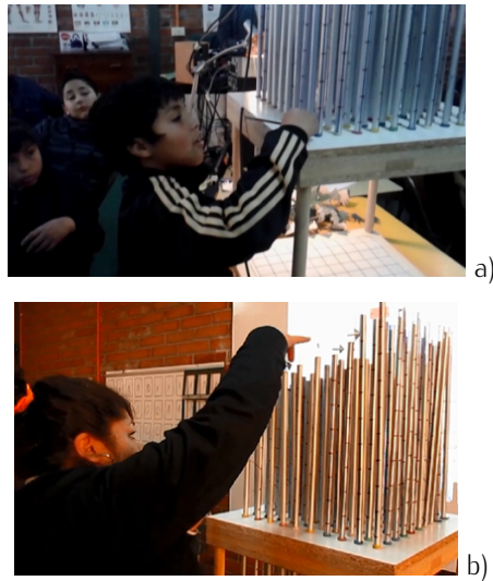
Figura 14: a) Estudiante contando marcas en barra de aluminio para luego registrar elevaciones. b) Estudiante colocando veletas que se girarán por acción del viento una vez se encienda el ventilador.
