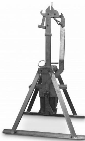
**Fig 8 – Struttura del Box Corer**
