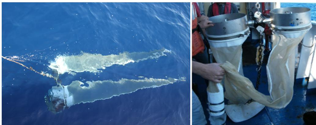
Fig. 5 - Bongo 40 - strumento funzionale per il campionamento di zooplancton e ittioplancton
