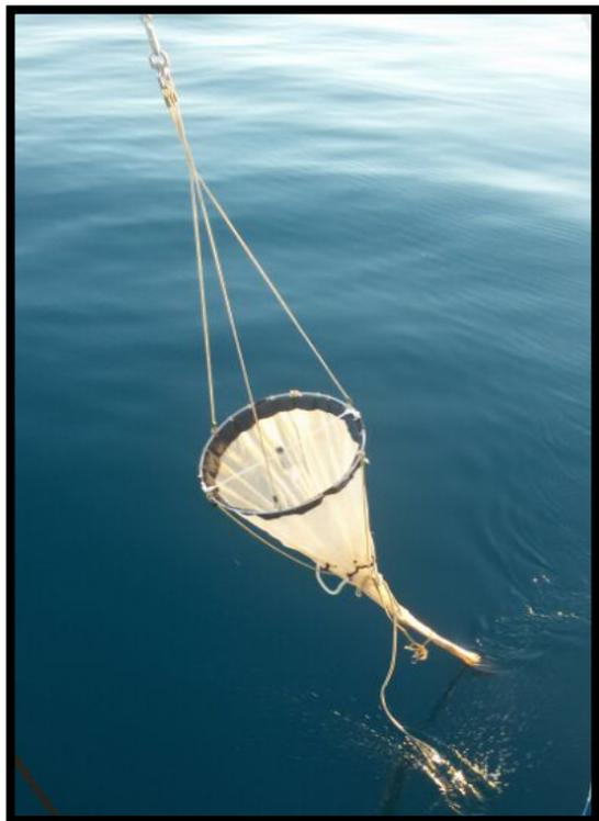
*Fig.5 Retino WP2 campionatore universale utilizzato normalmente per la raccolta verticale dello zooplankton*
