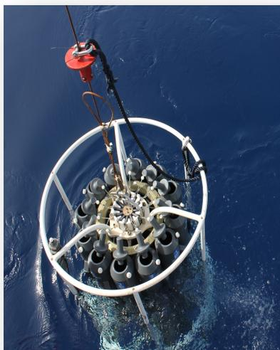
*Fig.2 Sonda multiparametrica SBE 9/11 plus montata alla base del CTD*
