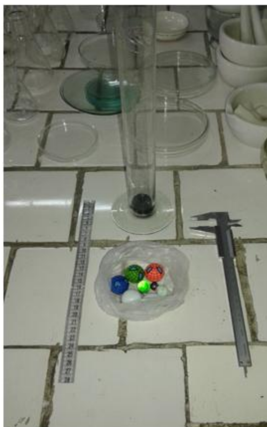
Figura 7: Elementos de trabajo. Probeta, bolsa con bolitas, centímetro, calibre.
