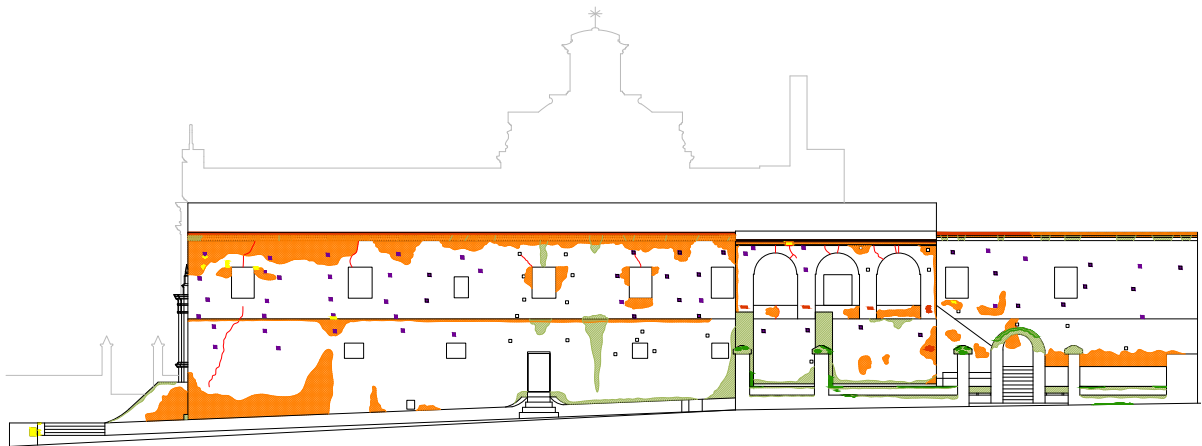
Ilustración 32: Relevamiento de lesiones - Fachada Norte
