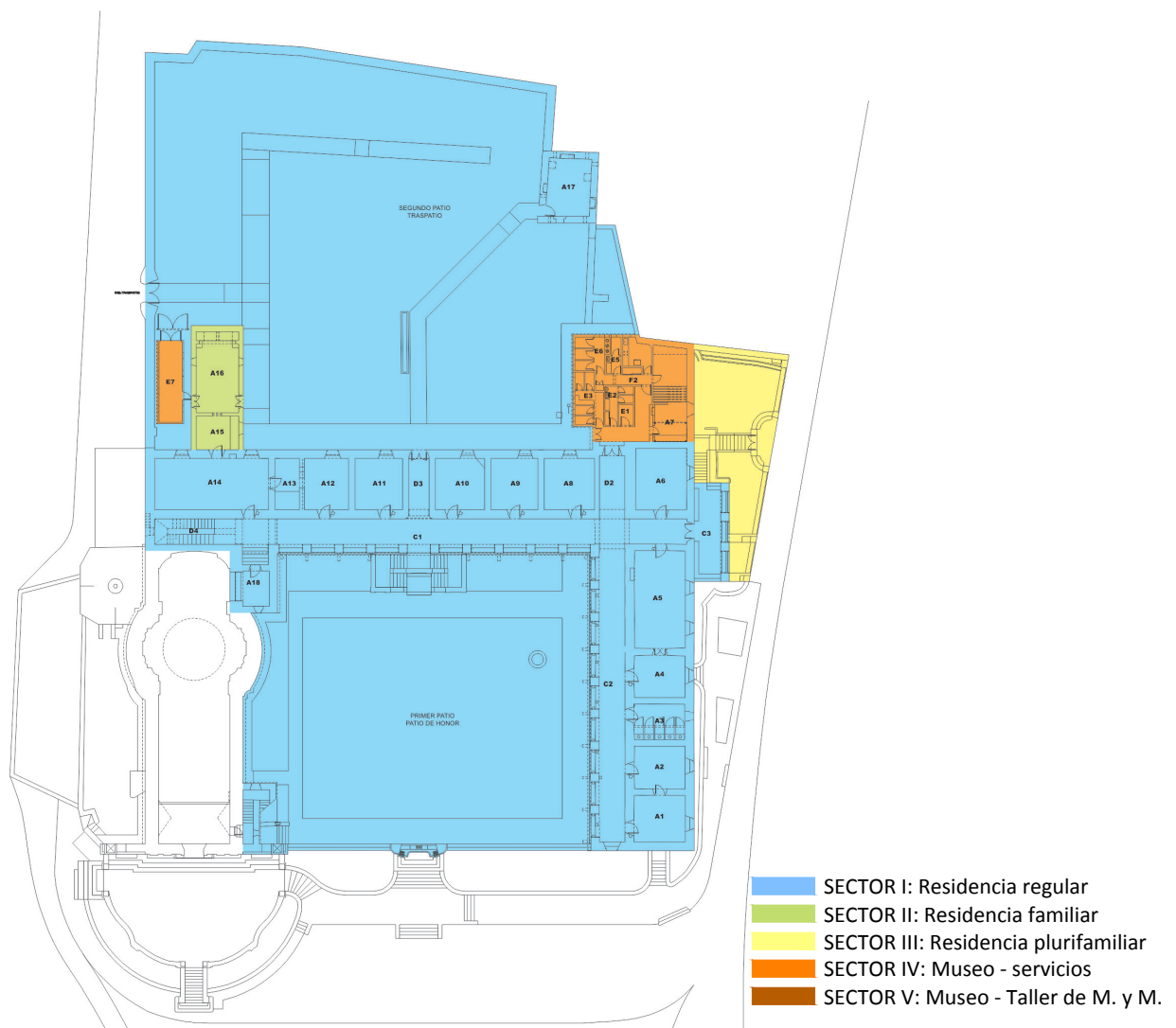
Ilustración 28: Sectorización por sistema constructivo
