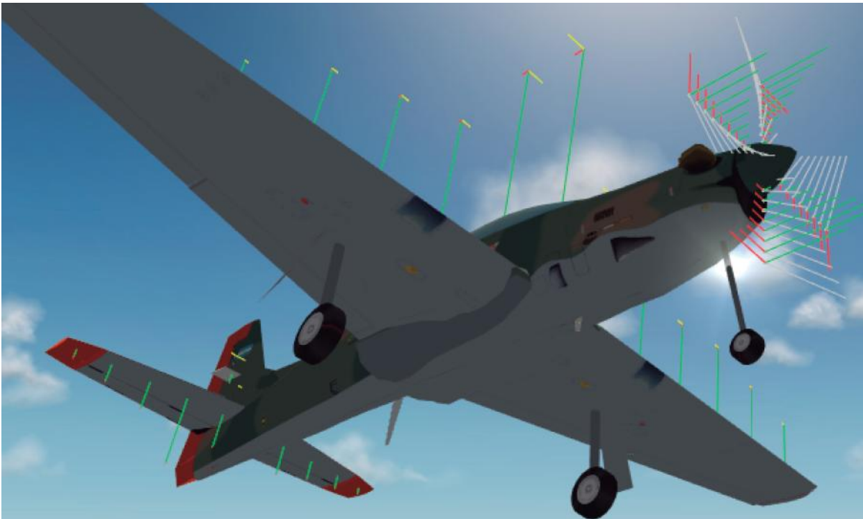
Figura 4 – Visualización de las fuerzas propulsivas y de sustentación sobre las diferentes superficies sustentadoras en "X-Plane 10".
