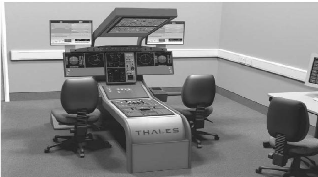
Figura 3- Dispositivo entrenador de vuelo “FSTD” de la empresa Thales .
