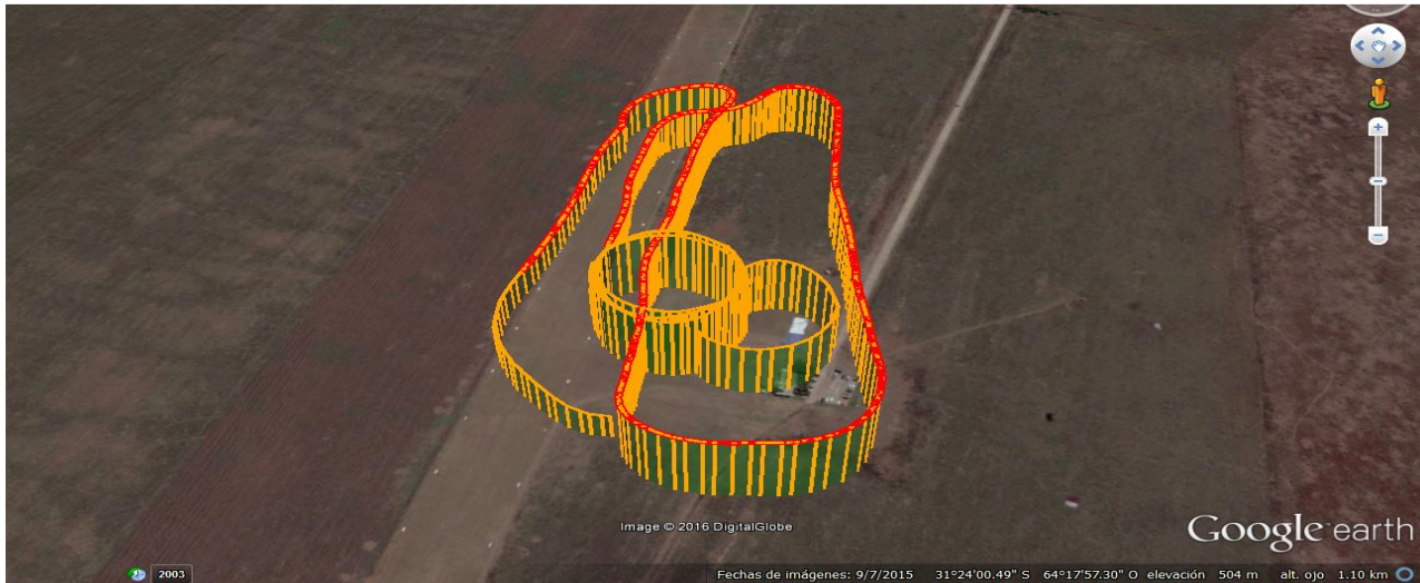
Figura 66 – Trayectoria de vuelo obtenida por la aeronave real en modo de vuelo autónomo “Auto”.
