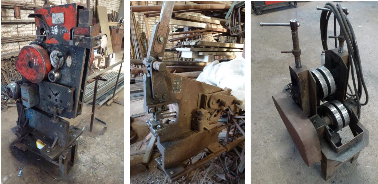
Figura 4 – De izquierda a derecha: cizalla eléctrica para corte de perfiles de acero, punzonadora manual y curvadora de perfiles.
