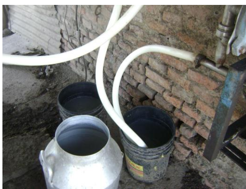
Figura 12: Depósito transitorio abierto al ambiente
