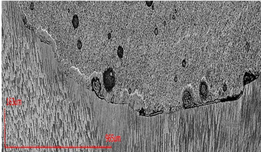
Figura 44: Interfase dentina - cemento de ionómero de vidrio de triple curado Vitremmer, perteneciente al grupo 2-1. OLS4000 3D LEXT x860.
