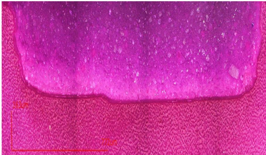
**Figura 86:** Micrografía de la interface dentina - cemento de ionómero de vidrio GC Gold Label 9, que pertenece al grupo 6, muestra 4. OLS4000 3D LEXT x860
