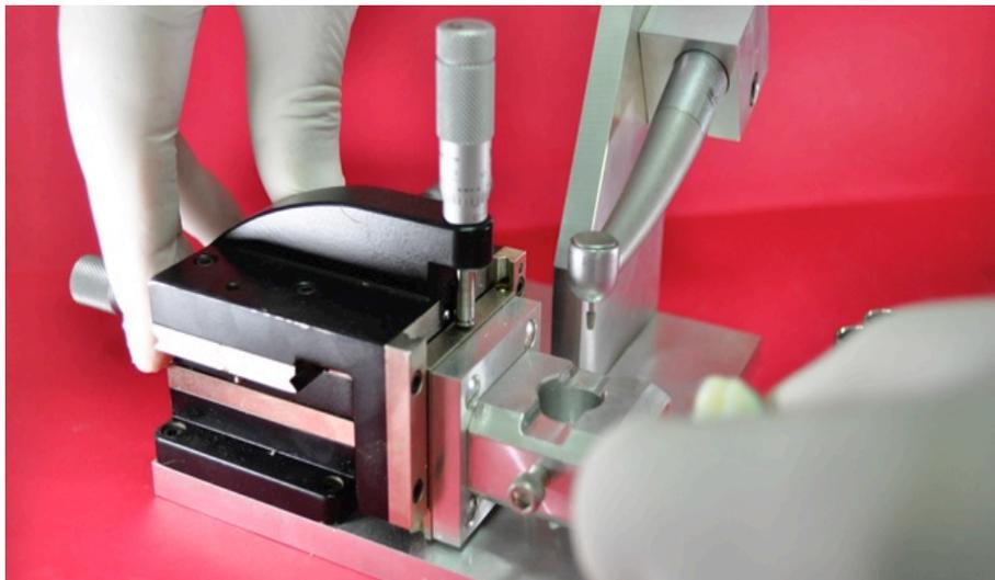
**Figura 7:** Estandarizador de Preparaciones Cavitarias creado, diseñado y realizado especialmente para esta investigación, donde se insertaron los dientes con los tubos de acero inoxidable. En cada uno de los dientes se prepararon cavidades estandarizadas de Clase 1 oclusales simples en forma de ranura, con una profundidad de 4mm, un diámetro mesio-distal de 4mm y un diámetro buco-lingual de 3mm.
