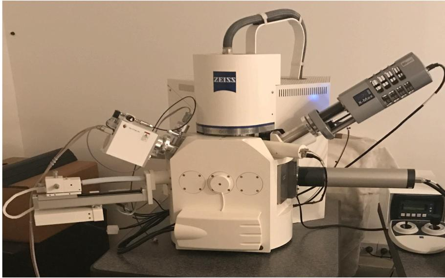
**Figura 30:** Cañón y Detectores del Microscopio Electrónico de Barrido de Emisión de Campo FEG SEM, (Zeiss, Germany), LAMARX Universidad Nacional de Córdoba.
