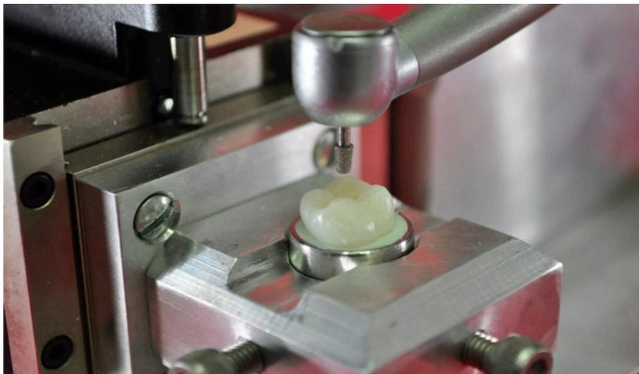
**Figura 9:** *Mesa de soporte de los dientes del Estandarizador de Preparaciones Cavitarias, con la piedra diamantada y la turbina de ultra-alta velocidad en posición de trabajo para el tallado de las preparaciones cavitarias.*
