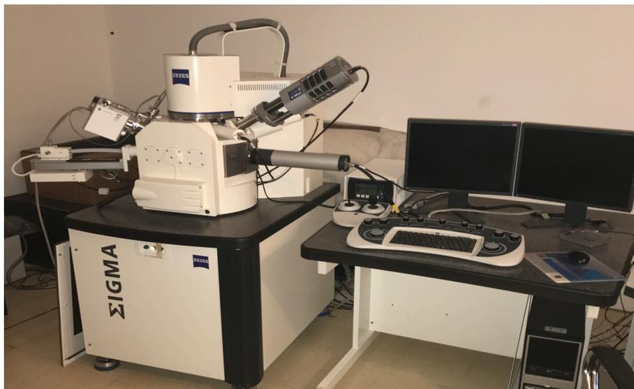
**Figura 29:** Microscopio Electrónico de Barrido de Emisión de Campo FEG SEM con EDS. LAMARX UNC.
