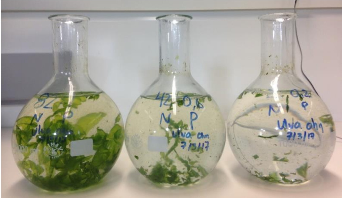
Figura 10: Botellones con biomasa procedente de la experiencia final, se observan de izq. a dcha. mayor a menor concentración de nutrientes [N/P]: 82/1, 42/0,6, 2/0,2 respectivamente. Se observó mayor tasa de crecimiento en la de mayor concentración de ambos elementos.
