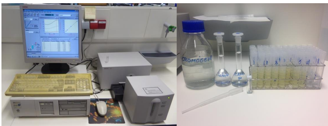
Figura 2: Espectrofotómetro (izquierda); Instrumental para la determinación de fosfato (derecha).
