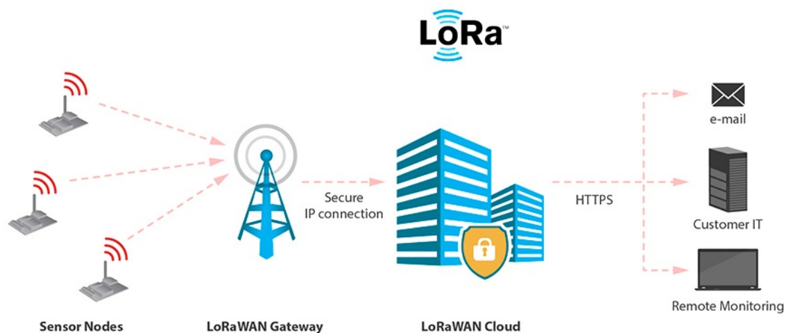
Ilustración 4.2.6: Configuración de Red por Conexión Directa a Gateway LoRaWAN™.
