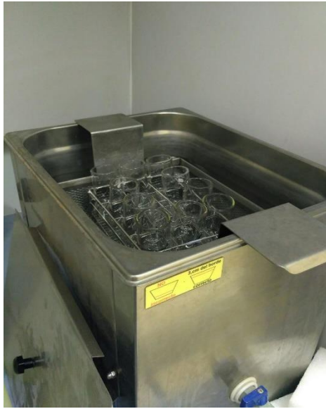
Figura 5: Baño de ultrasonidos al que fueron sometidas las muestras para eliminar cualquier impureza que pudiera influir en los análisis. Fuente: Fotografía propia.
