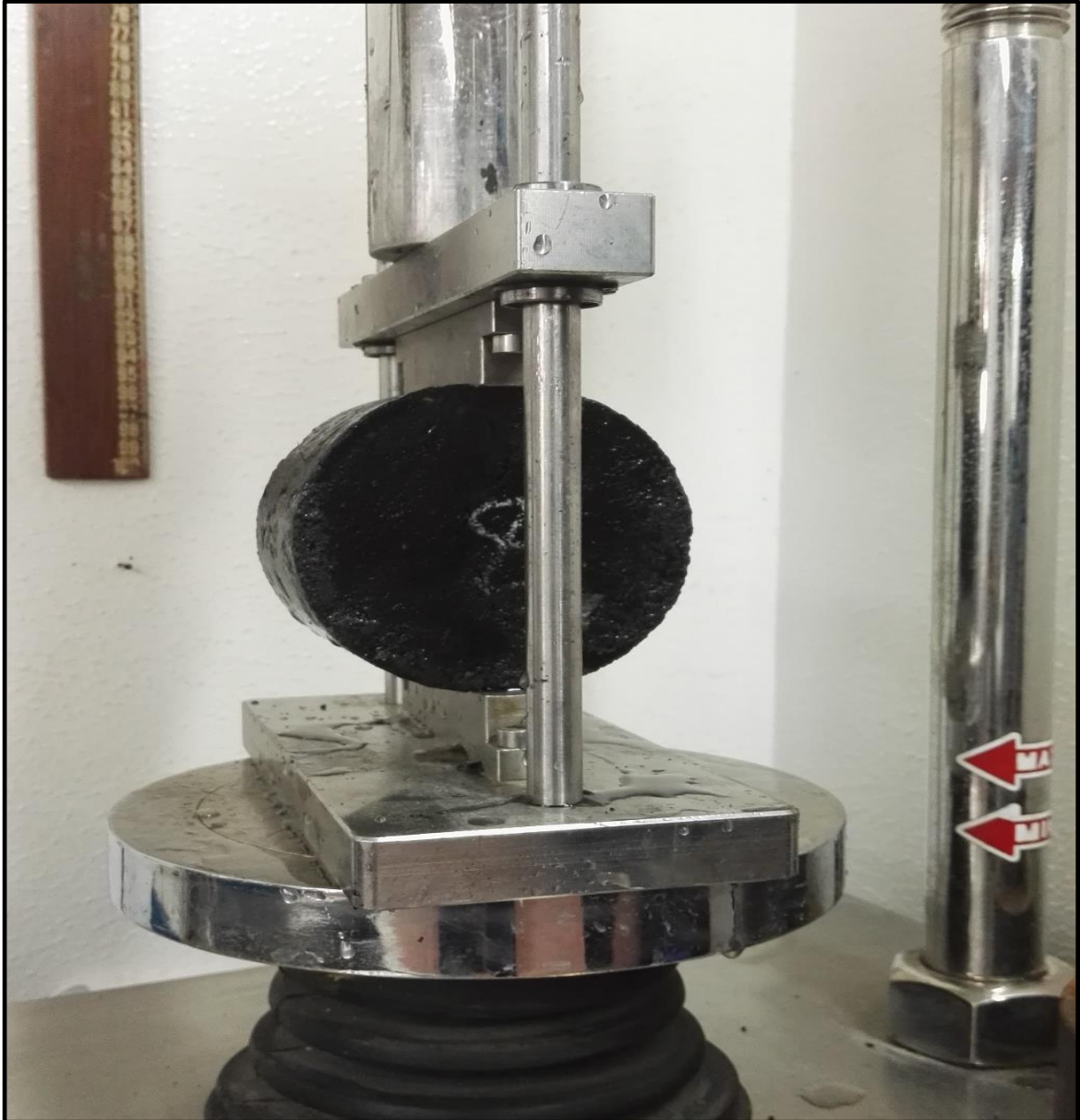
Figura 10. Probeta sometida al ensayo tracción indirecta
