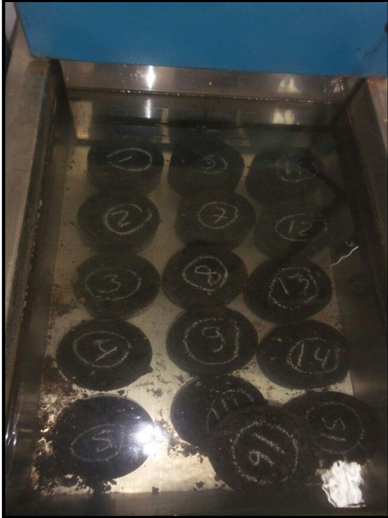
Figura 8. Acondicionamiento de las probetas saturadas
