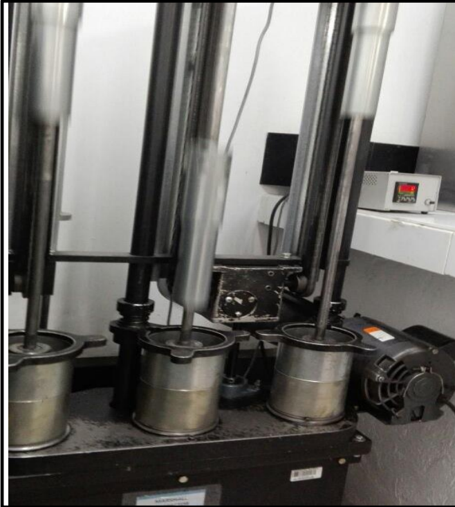
Figura 6. Prensa para compactar las probetas
